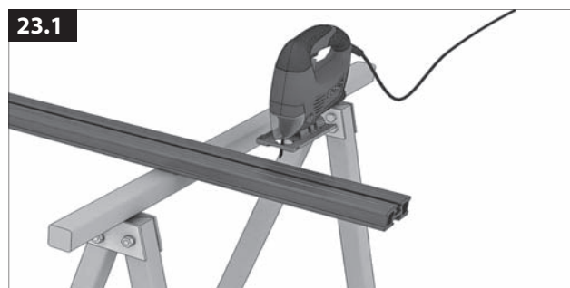
Zuschneiden der UK-Profile.
