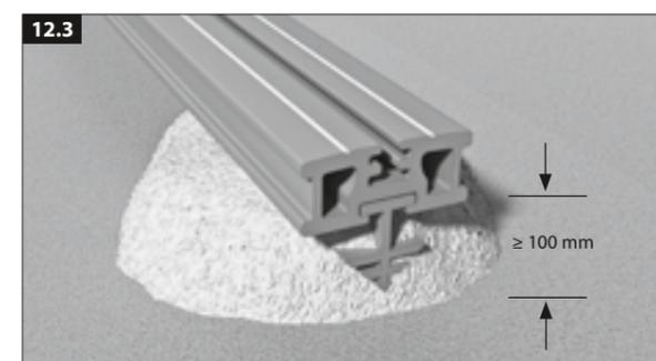
**Variante 3:** Befestigen mit Betonankern
